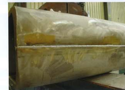
Figuur 5 - Gelaste waterkamers, Incoloy 825, 23 mm dik en circa vier meter lang
