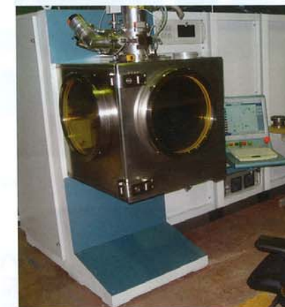
Figuur 4 - Een EB-las-machine van Schelde Exotech
